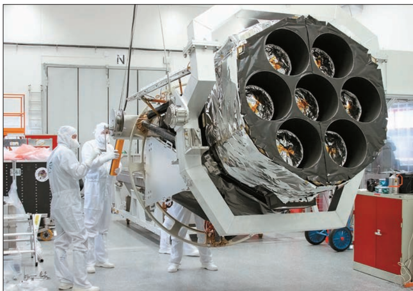
Рис.10. Общий вид телескопа eРозита обсерватории Спектр-Рентген-Гамма. Высокая чувствительность и большое поля зрения позволят вести поиск переменных источников во время обзора всего неба (снимок печатается с разрешения Института внеатмосферной физики общества Макса Планка — МПЕ).
